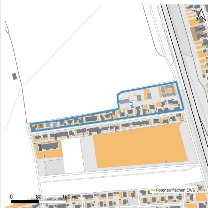
Nutzung von oberflächennaher Geothermie durch Erdwärmesonden
