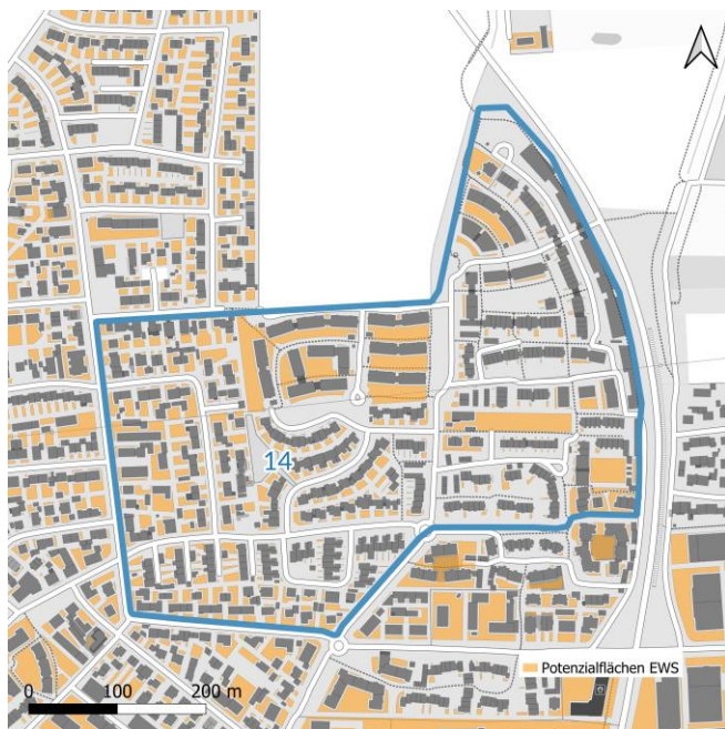
Nutzung von oberflächennaher Geothermie durch Erdwärmesonden
