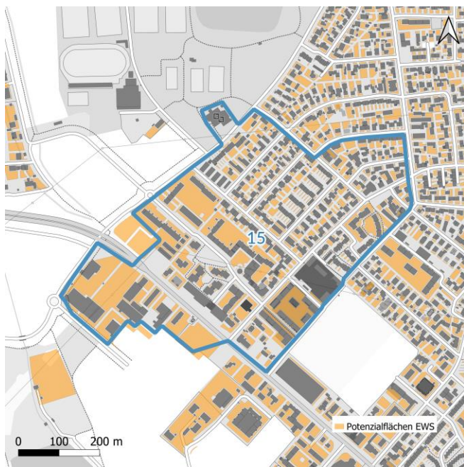
Nutzung von oberflächennaher Geothermie durch Erdwärmesonden
