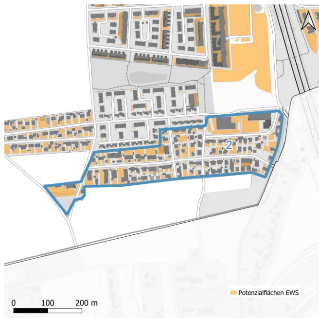
Nutzung von oberflächennaher Geothermie durch Erdwärmesonden
