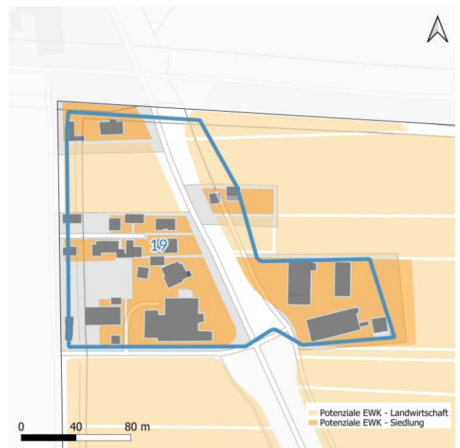
Nutzung von oberflächennaher Geothermie durch Erdwärmekollektoren
