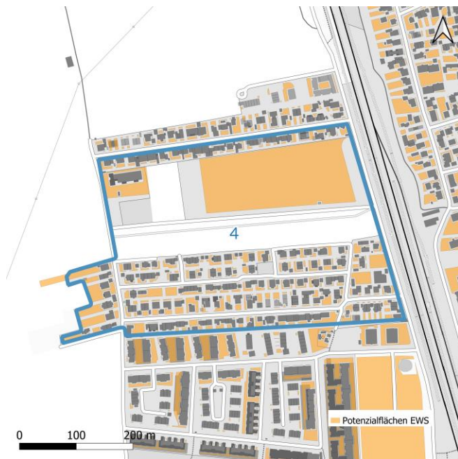
Nutzung von oberflächennaher Geothermie durch Erdwärmesonden
