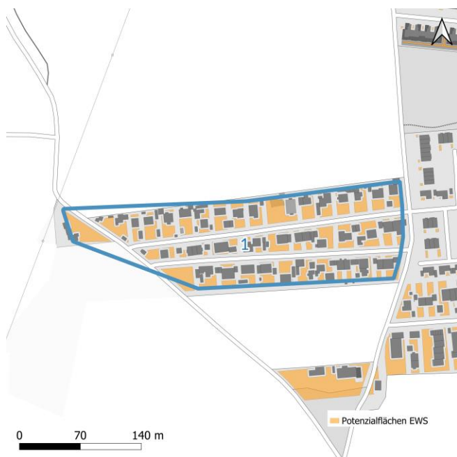
Nutzung von oberflächennaher Geothermie durch Erdwärmesonden
