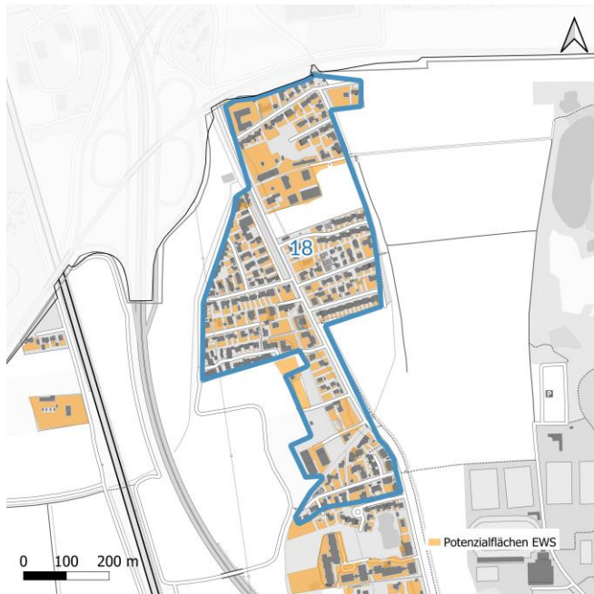
Nutzung von oberflächennaher Geothermie durch Erdwärmesonden
