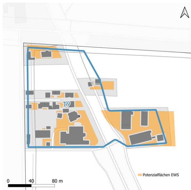
Nutzung von oberflächennaher Geothermie durch Erdwärmesonden
