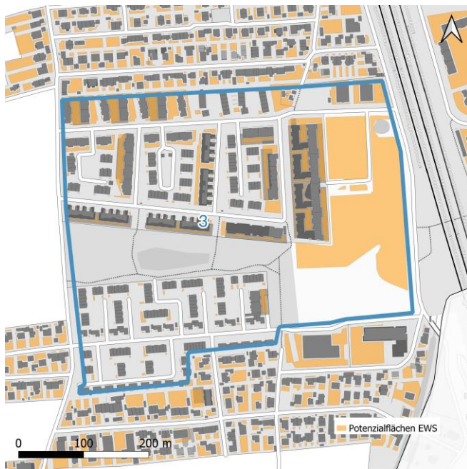
Nutzung von oberflächennaher Geothermie durch Erdwärmesonden
